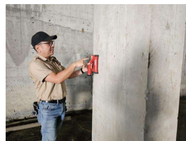
Gambar 16. Proses pengujian posisi tulangan baja
