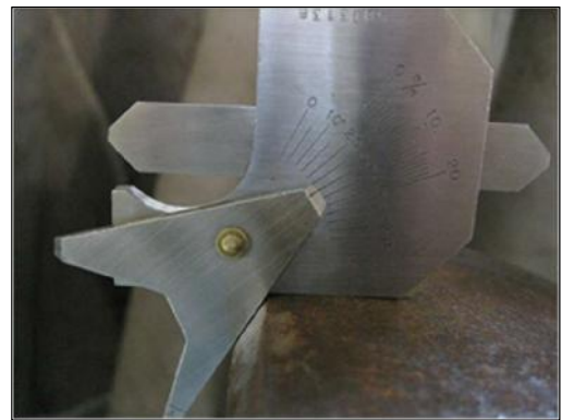
Gambar 10, Sudut kampuh pada longitudinal seam.
