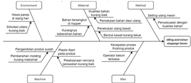
Gambar 5. Fishbone diagram untuk idling & minor stoppage losses
