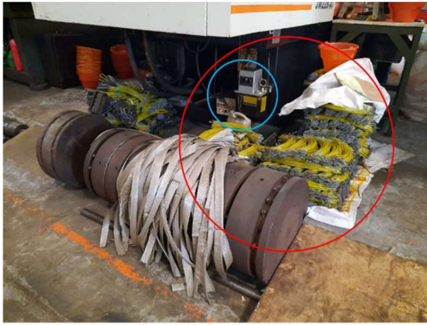
Gambar 8. Tumpukan kawat di area pompa lubrikasi
