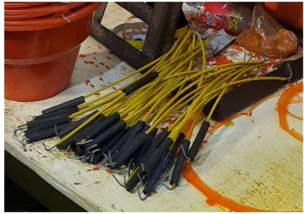
Gambar 9. Bentuk gagang kawat yang kurang tertekuk
