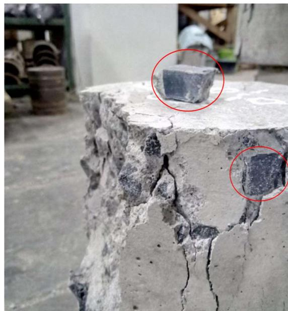
Gambar. 8. Kondisi Beton Setelah Dilakukan Pengujian Kuat Tekan
